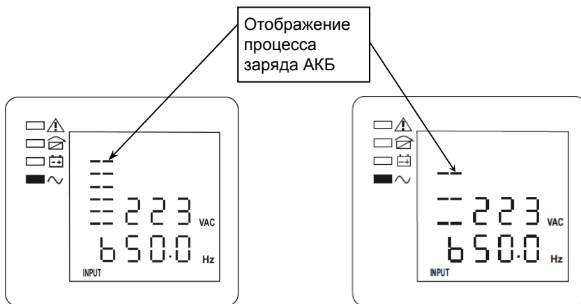
Рисунок 21 — ЖК-дисплей, форсированный (ускоренный) заряд АКБ
